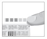
► Lea el grado de dureza del agua según la coloración de la tira reactiva Aquadur® con ayuda de la descripción que aparece en el embalaje.
